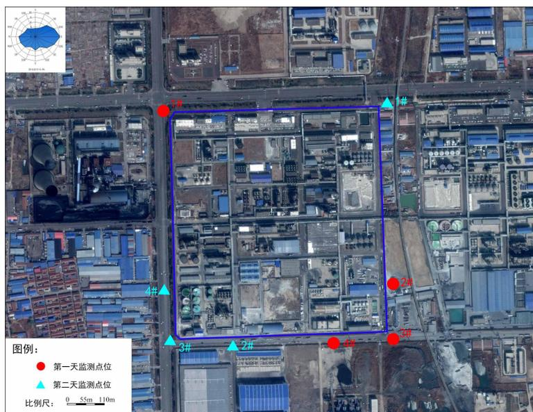
图 2.2-13 东瑞化工无组织废气监测布点图
